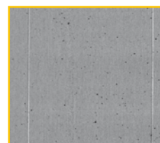
Streifen (Streaks) in der Beschichtung
