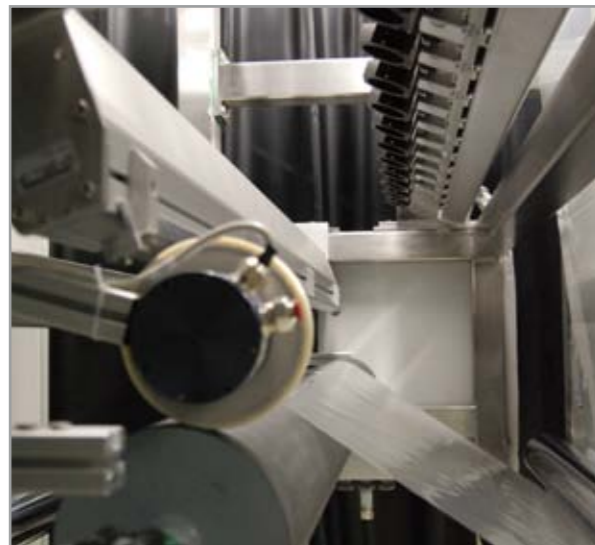
EasyInspect von Dr. Schenk für die Inspektion von Folienmaterial, hier in Reflexion
