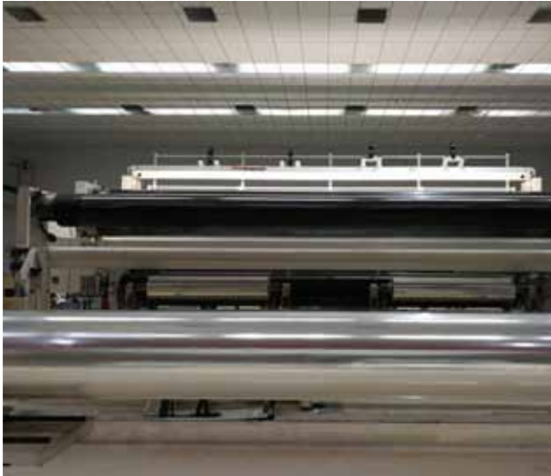
EasyInspect von Dr. Schenk für die Inspektion von Folienmaterial
