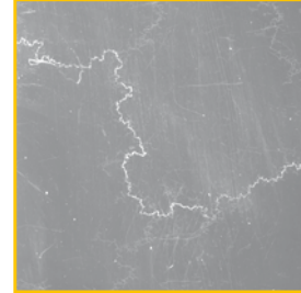
裂纹/电弧缺陷
