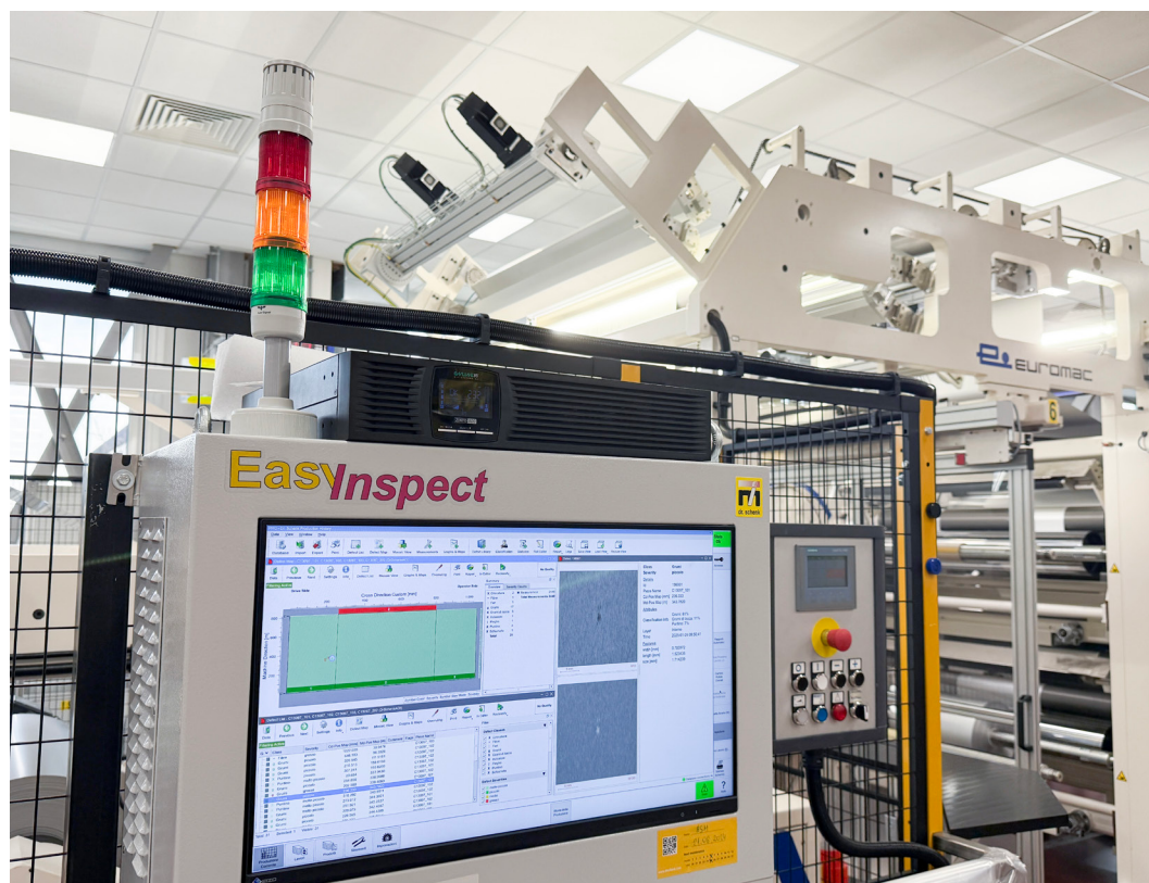
Die neue Euromac Schneid- und Wickelmaschine ist mit Kamerainspektionslösungen von Dr. Schenk ausgestattet
