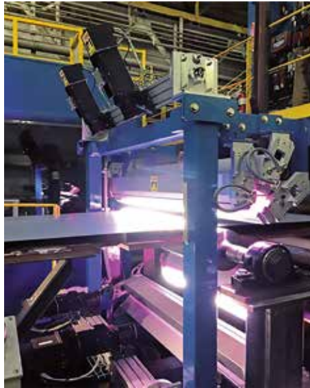
Abbildung 1: Kamerabasiertes Oberflächeninspektionssystem mit entsprechender LED-Lichttechnik an einer Galvanisierungsline
