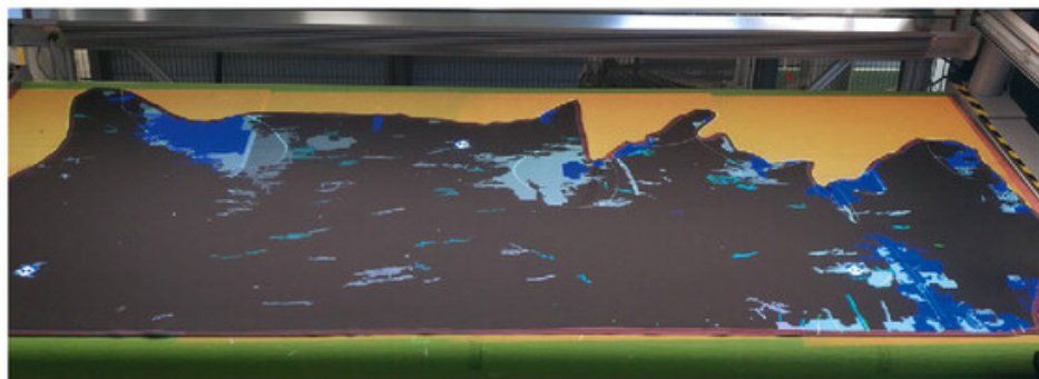
Den natürlichen und durchaus teuren Werkstoff Leder digital scannen, die Fehler detektieren und direkt im Anschluss materialsparend schneiden – das ist keine Zukunftsmusik mehr.
